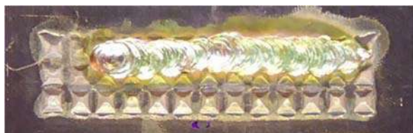
図7 超音波+Hybrid 集電体溶接（裏面）
