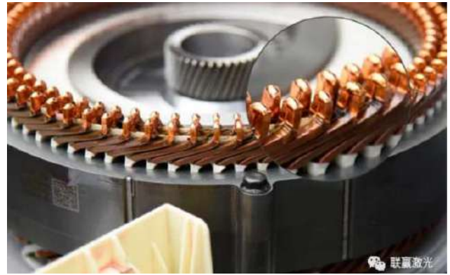
図 11 車載モータ銅端子溶接
