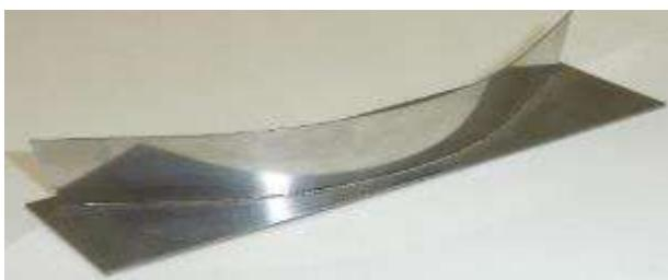
図16 曲面状の薄板溶接
