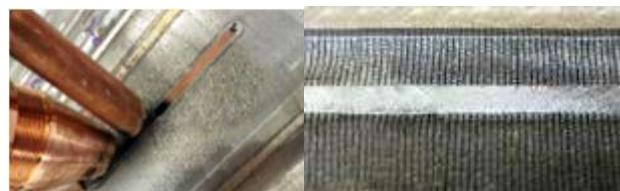
図27 電磁鋼板溶接例
