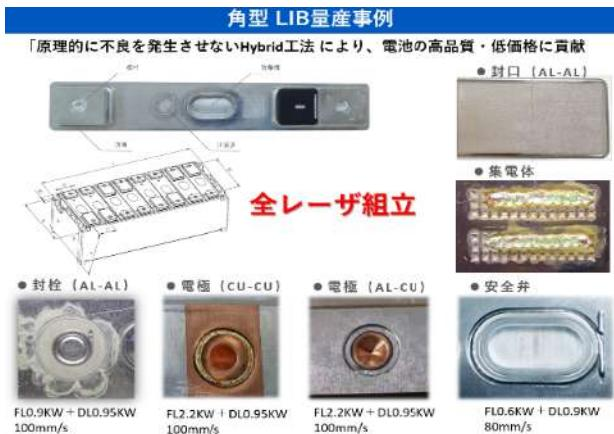
図3 EV用角型LIBレーザ溶接機
