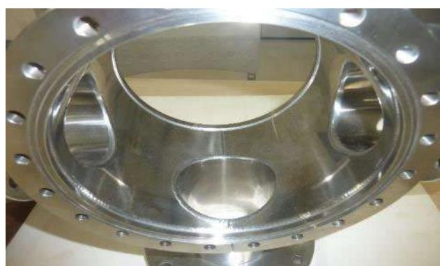
図6 真空装置TIG溶接品内面
