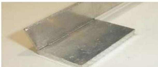
図15 热容量が極端に異なる溶接
