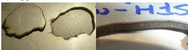
図24 小型 SFH ハンドレーザ切断例
