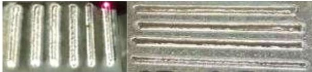
図22 亜鉛鍍金鋼板溶接焦点深度
