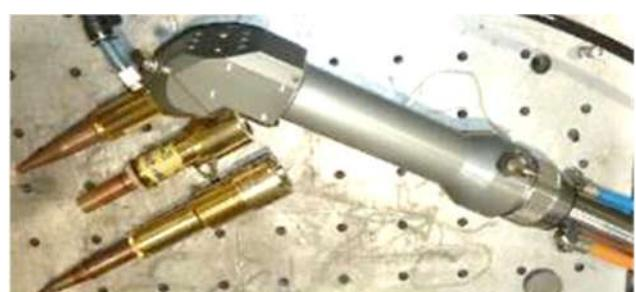
図21 ノズル交換式小型SFHハンドレーザ試作品
